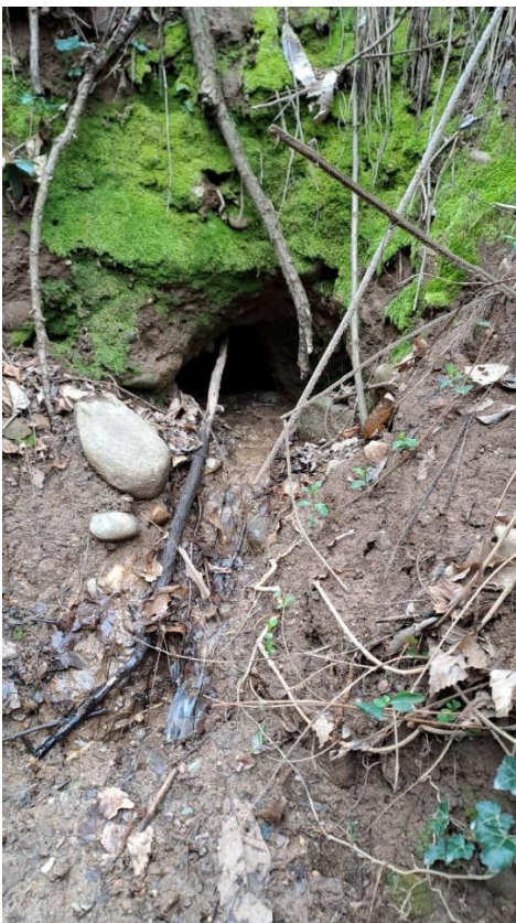
Figura 3.9 condotta di piping alla sommità della scarpata (R6)
