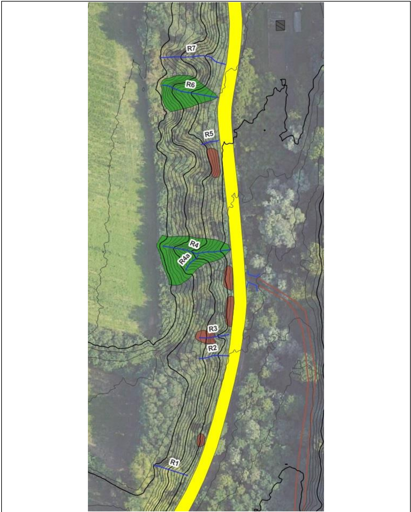
Figura 3.2 rilievo geomorfologico della scarpata (Rx=ID solchi di ruscellamento; marrone=affioramenti di conglomerato; verde=impluvio; giallo=via Piana di Luco). Base topografica derivata da aerofotogrammetria da drone
